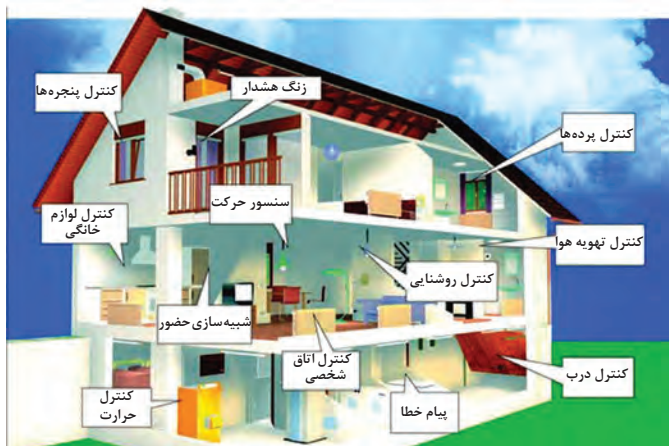
شکل ۲۱-۵- حسگرهای استفاده شده در یک خانه هوشمند
